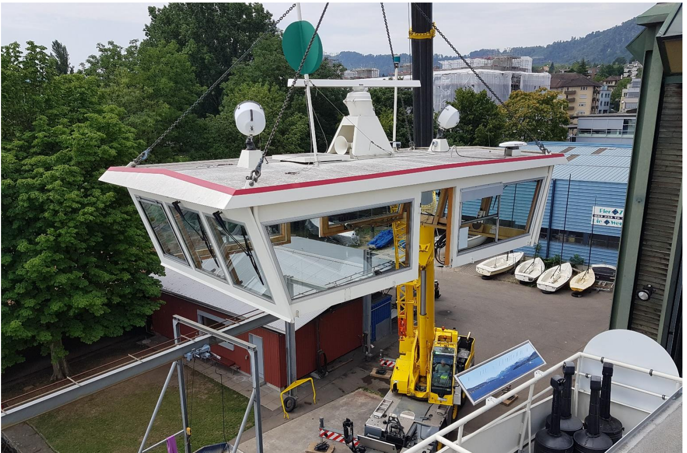
Das Steuerhausdach der Horgen demontiert – Fähre für ZSG-Halle sonst zu hoch (10. Juli 2023)
